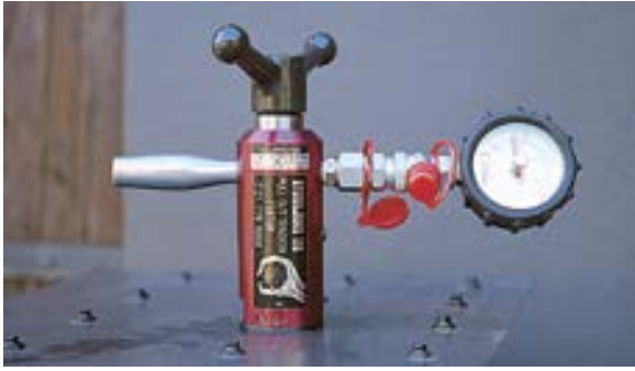
Testing av uttrekkskraft i stålprofil
